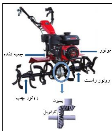
شکل ۱- تیلر (کولتیواتور) باغی ویما (WEIMA 1100 AE) ۹ اسب بخار Fig. 1- Two-wheel Tractor of garden (Tiller, WEIMA 1100 AE)
