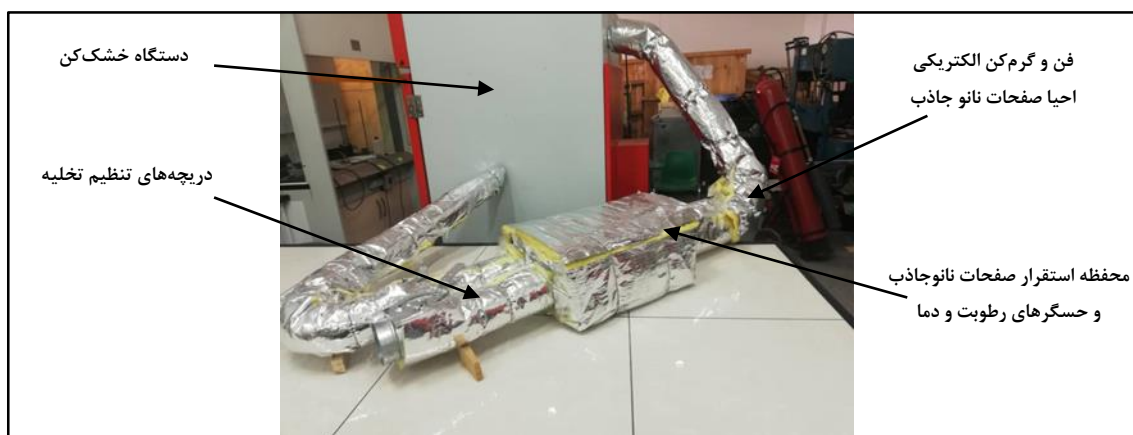
شکل ۲- خشک کن، لوله‌های ارتباطی، مخزنه نانوجاذب
