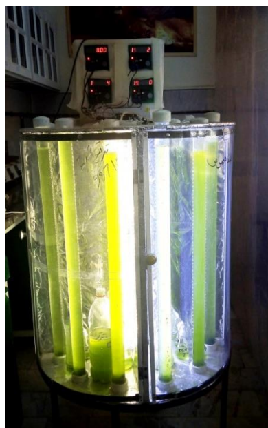
شکل ۱- فتوبیوراکتور عمودی ساخته شده برای استفاده در آزمایش‌ها Fig. 1- Vertical photobioreactor made to be used in the experiments
