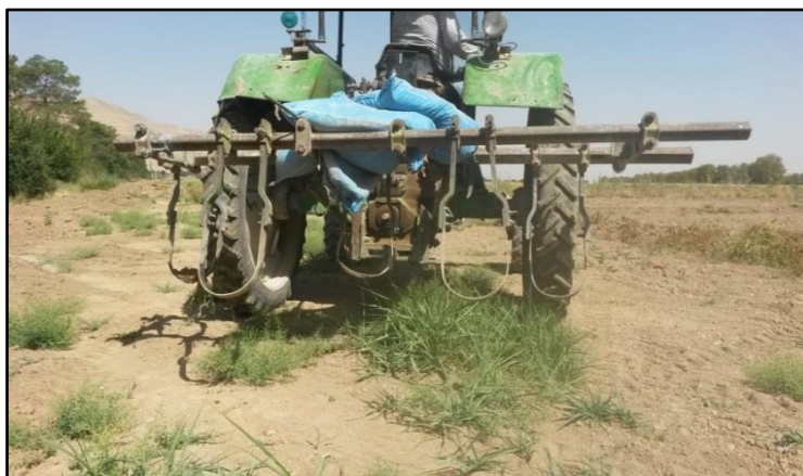
شکل ۴- کولتیواتور هلالی استفاده شده در پژوهش Fig. 4- The used crescent cultivator in research
