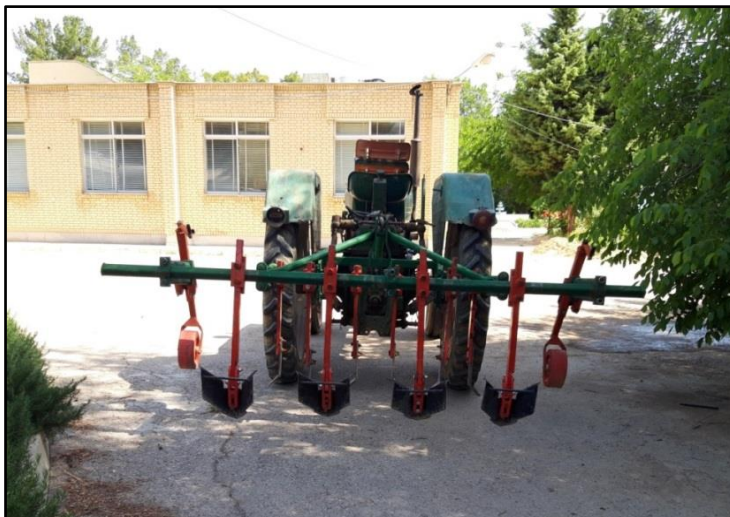
شکل ۳- کولتیواتور کج ساق استفاده شده در پژوهش Fig. 3- The used bent leg cultivator in research
