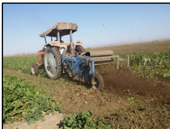
شکل ۲- برگ‌زنی و طوقه‌زنی در روش برداشت مکانیزه چند مرحله‌ای
