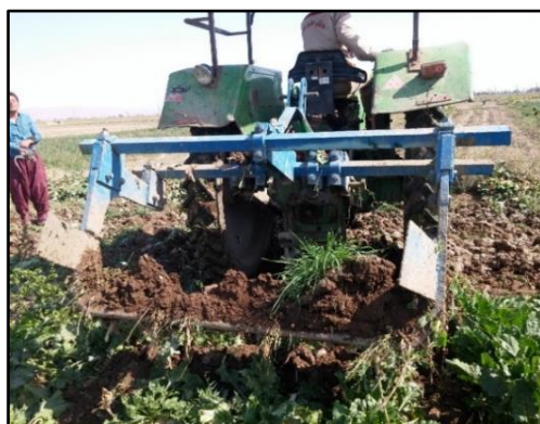
شکل ۵- کندن چغندر قند در روش برداشت نیمه مکانیزه
