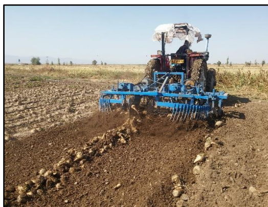
شکل ۳- کندن و ردیف کردن چغندر قند در روش برداشت مکانیزه چند مرحله‌ای Fig. 3. Sugar beet lifting and aligning in multi-stage harvesting method
