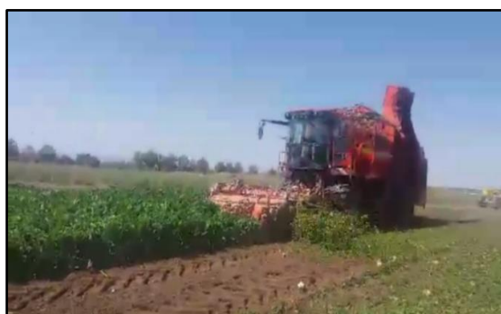
شکل ۱- کمباین برداشت چغندر قند هولمر ساخت آلمان
