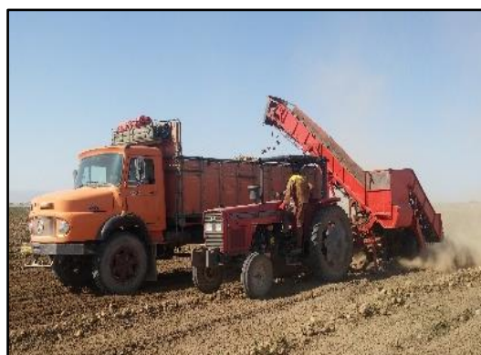
شکل ۴- بارگیری در روش برداشت مکانیزه چند مرحله‌ای Fig. 4. Sugar beet loading in multi-stage harvesting method
